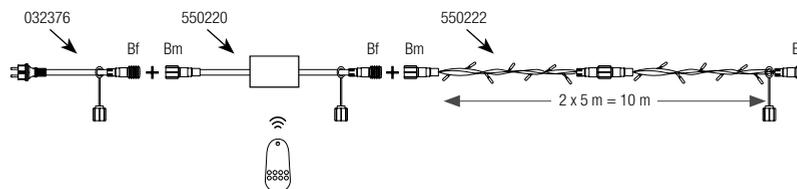
**Gamme 230V :** Prévoir une alimentation non redressée et un contrôleur. Compatible avec nos accessoires P&L.
