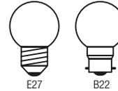
Les ampoules E27 et B22 diffèrent par leur type de culot. L'E27, avec son culot à vis de 27 mm, est le modèle le plus couramment utilisé. Le B22, quant à lui, possède un culot à baïonnette de 22 mm.
